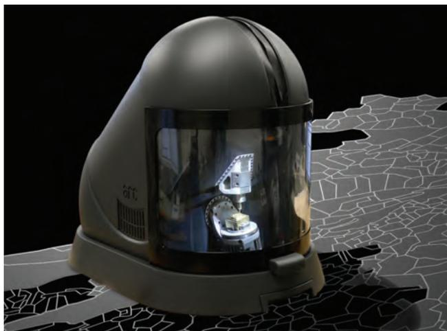
Développée dans le cadre du programme EcoSwissMade, la machine micro5 n'est pas encore industrialisée, mais les tests d'usinage de laiton et d'innox réalisés avec le prototype sont très prometteurs. La HE Arc recherche des partenaires pour sa production et sa commercialisation.
