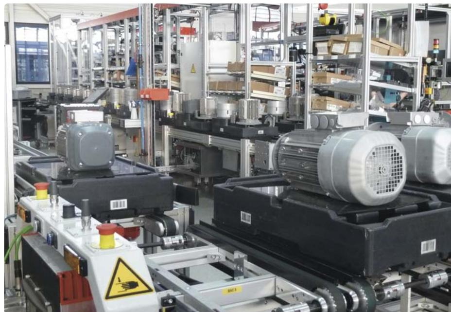
Transfert d'éléments en cours de montage d'un chariot AGV à un îlot d'assemblage dans l'usine SEW USOCOME.
