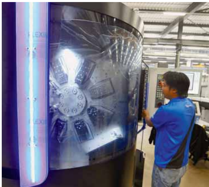
Une décolleteuse Tornos, prête à quitter Moutier. Pesant huit tonnes, elle peut usiner huit barres en même temps, avec 26 outils. ROLLAND KELLER
