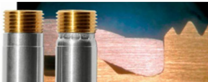
Le «sertissage» en tant que procédé d'assemblage, dans lequel deux composants sont assemblés par déformation plastique, est un assemblage extrêmement durable.
